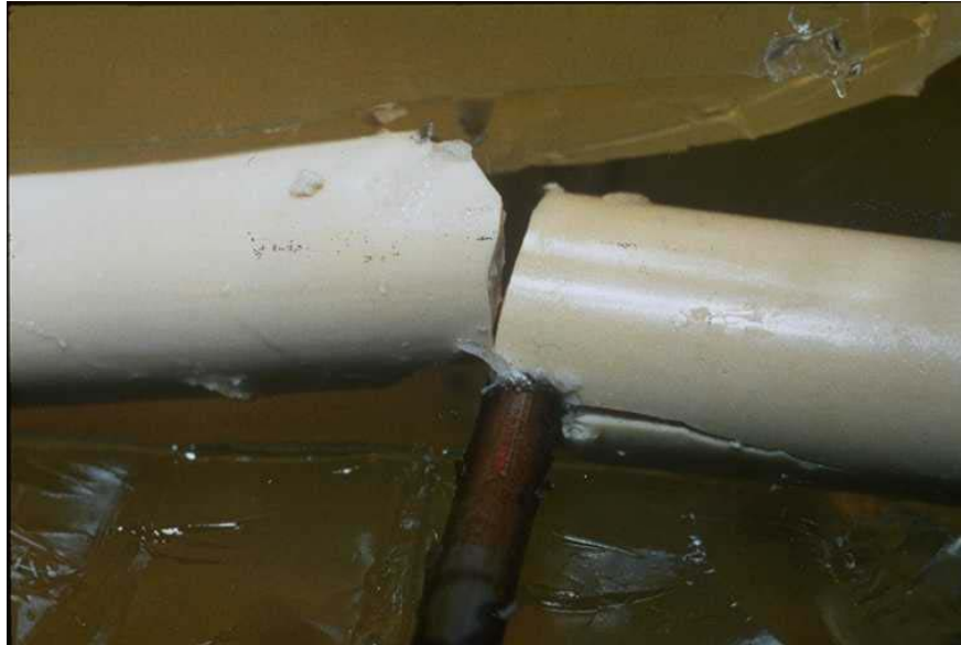
Abb. 3.-3. Kunstknochen: Schussbruch mit Radiärfraktur und Biegungskeil durch Feldspitze (Pfeil Nr. 130)
