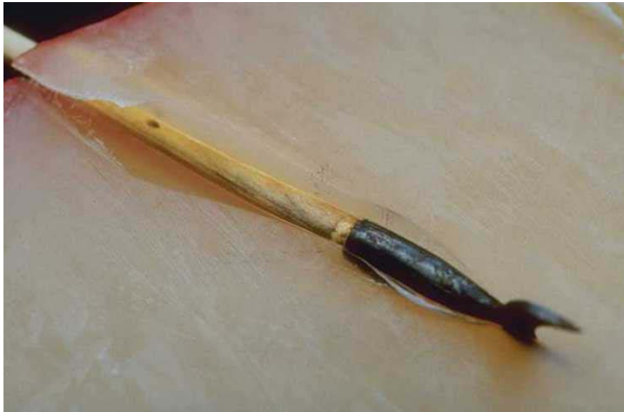
Abb. 3.-5. Halbmond in Seife: Schraubenförmiger Schusskanal (Pfeil Nr. 80)
