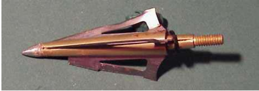
Abb. 3.-39. Verbiegungen und Klingenbrüche bei Jagdspitze nach Oberschenkelzertrümmerung (Pfeil Nr. 72). vgl. Abb. 3.-22 und 3.-23.
